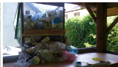
Rys. 5 Elementy sortowni doświadczalnej w czasie pracy: zasobnik na odpady (zdjęcie po lewej stronie); ten sam zasobnik po podniesieniu zastawki i przekazaniu części odpadów na stół sortowniczy (zdjęcie powyżej); urządzenie do mycia – wanna z hydro-masażem.
