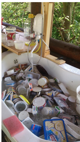
Rys. 5 Elementy sortowni doświadczalnej w czasie pracy: zasobnik na odpady (zdjęcie po lewej stronie); ten sam zasobnik po podniesieniu zastawki i przekazaniu części odpadów na stół sortowniczy (zdjęcie powyżej); urządzenie do mycia – wanna z hydro-masażem.
