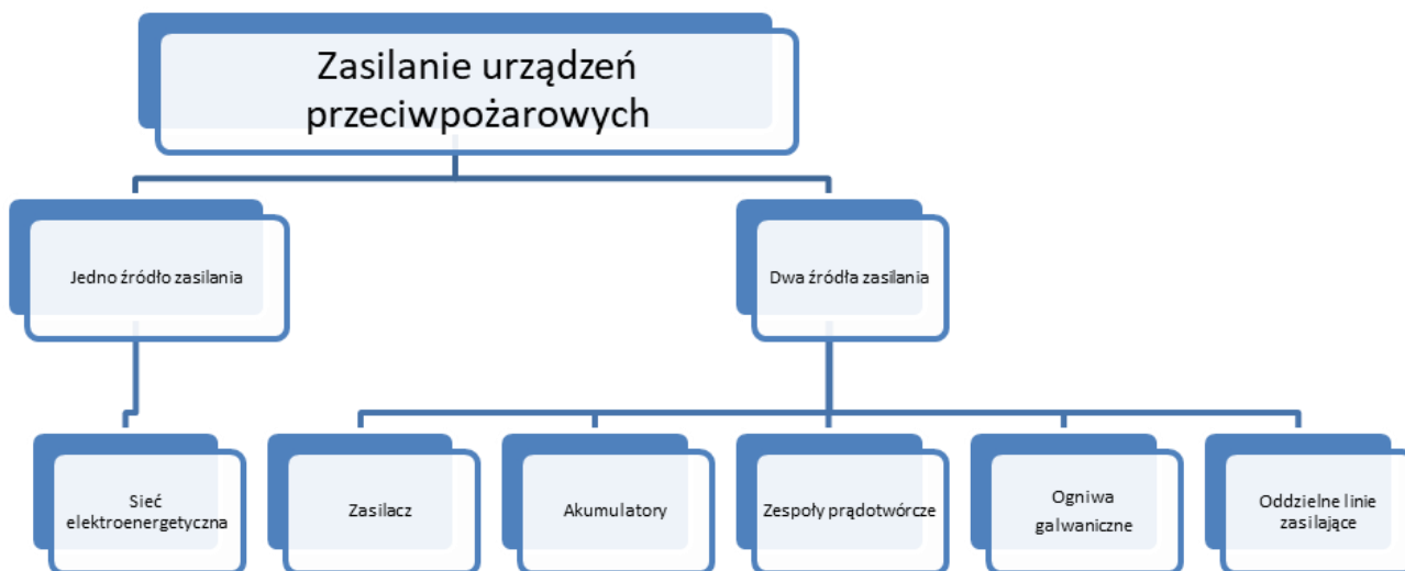
Rys.1. Wymagania dla zasilania urządzeń przeciwpożarowych
